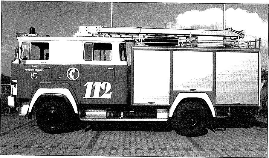
LF 16. Magirus Deutz, zul. Gesamtgewicht 11,5t, 170 PS, Allrad, Baujahr 1977. Löschgruppenfahrzeug, 1600l Wassertank, Feuerlöschkreiselpumpe 16/8, Besatzung: 1/8. Drittes Fahrzeug im Löschzug und bei Verkehrsunfällen. Ausrüstung: 60m Schnellangriff, 4 Preßluftatmer, Löschausrüstung, Schiebleiter (14m), 4-teilige Steckleiter (8,4m), Hakenleiter (4,4m), Höhensicherungsgerät, Druckbelüfter (Tempest), Stromerzeuger 5kVA, Beleuchtungseinrichtung. Gefahrene Einsätze im Jahr 2000: 34
