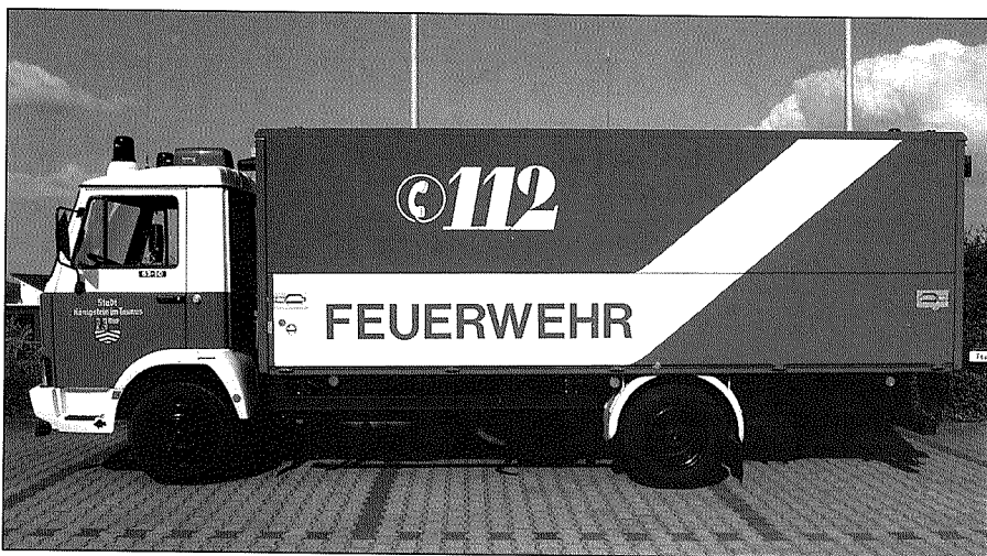
GF-G 1. Iveco Fiat, zul. Gesamtgewicht 6,7t, 100 PS. Gerätewagen Gefahrgut, Besatzung 1/2 Gerätewagen für Gefahrgutunfälle aller Art, auch überörtliche Anforderungen. Ausrüstung: 3 Preßluftatmer, 3 Chemiekalienschutzanzüge, Geräte zum Auffangen und Pumpen gefähr- licher Flüssigkeiten, Dichtkissen, diverse Materialien zum Abdichten, diverse Meßgeräte, Ge- fahrgutnachsschlagwerk Hommel, Gefahrgutsschlüssel, Beständigkeitslisten, Stromerzeuger 5kVA, Teleskop-Lichtmast, Ex-geschützte Stromversorgung. Gefabrene Einsätze im Jahr 2000: 23
