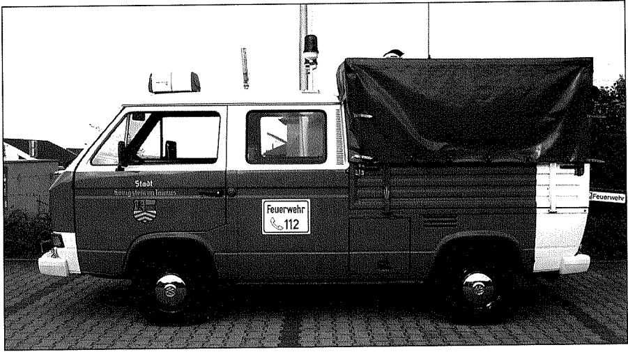
GW-VW. VW Transporter, zul. Gesamtgewicht 2,6t, 78 PS. Gerätewagen zum Transport von Mannschaft und Einsatzmaterialien. Ausrüstung: Tri-Blitz Verkehrswarneinrichtung, Feuerlöcher. Gefahrene Einsätze im Jahr 2000: 16
