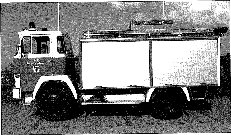
RF 1. Magirus Deutz, zul. Gesamtgewicht 8t, 120 PS, Allrad, Baujahr: 1976. Rüstwagen, Besatzung: 1/2. Erstes Fahrzeug bei Verkehrsunfällen, auch überörtliche Anforderungen. Ausrüstung: Festeingebauter Stromerzeuger 12kVA, Teleskop-Lichtmast, hydraulische Rettungsgeräte (Schere, Spreizer, Rettungszylinder), Seilwinde (bis 5t), Greifzug 1.6t, Hebekissen 5t, 4-teilige Steckleiter (8,4m), Kettensägen, Trennschleifer, Werkzeuge, Notfallkoffer, Airbagsicherung „Octopus“. Gefahrene Einsätze im Jahr 2000: 21
