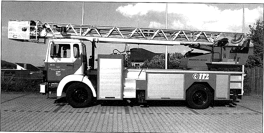
DLK 23-12. Iveco Magirus, zul. Gesamtgewicht 14t, 256 PS, ABS, Schleuderketten, Baujahr: 1993. Drebleiter mit Korb mit einer Rettungshöhe von 23m bei einer seitlichen Ausladung von 12m nach DIN (30m Leiterlänge), Besatzung 1/2. Zweites Fahrzeug im Löschzug, auch überörtliche Anforderungen. Ausrüstung: Rettungskorb für 3 Personen (280 kg), Wenderohr, Krankentragenhalterung für den Korb, 3 Preßluftatmer, Druckbelüfter (Tempest), Stromerzeuger 5kVA, elek. Kettensäge, Beleuchtungseinrichtung. Gefahrene Einsätze im Jahr 2000: 40
