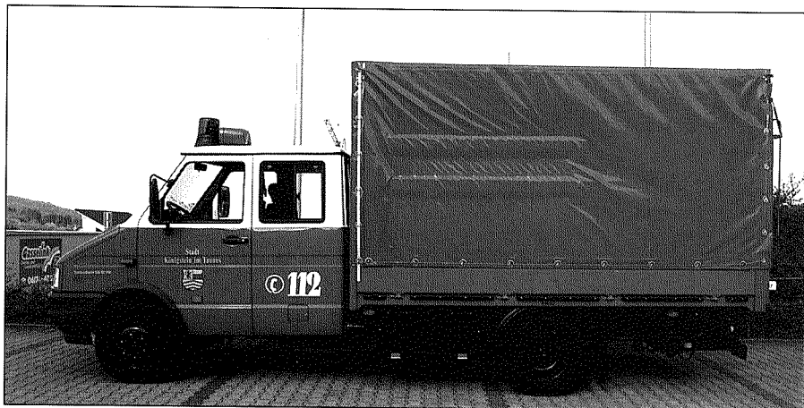
GF-N. Iveco Fiat (Daily Turbo), zul. Gesamtgewicht 6t, 125 PS, Ladebordwand 1t. Gerätewa- gen Nachschub, Besatzung: 1/5. Gerätewagen zum Transport von Einsatzmaterialien, Ein- satz bei Ölspuren. Ausrüstung: Ständig beladen mit: 400m B-Schlauch in Schnellabrollbehäl- tern, Ölbindemittel, Sicherungsmaterial, Behälter für aufgenommenes Ölbindemittel, Besen. Im Lager auf Paletten verlastet: Sandsäcke, Ersatzräder für alle Fahrzeuge, Tragkraftspritze 8/8, weitere B-Schläuche, wasserführende Armaturen, Bauholz, Schalttafeln, Baustützen. Gefabrene Einsätze im Jahr 2000: 29
